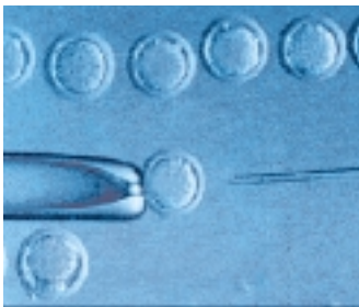
Zellmanipulation mit dem Mikro-roboter: Die Mikrogreifzange des Mikroroboters fasst und positioniert eine einzelne Zelle.
