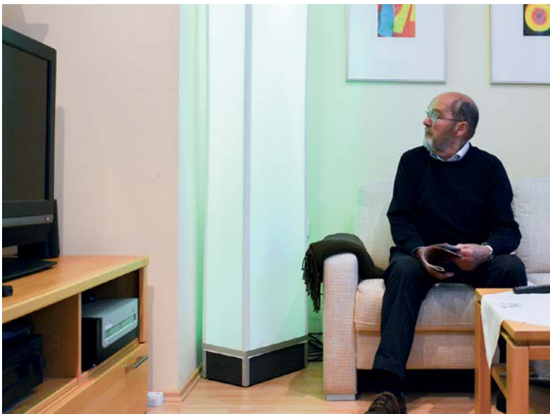
Ambientes Lichtsystem integriert in eine handelsübliche Stehlampe
