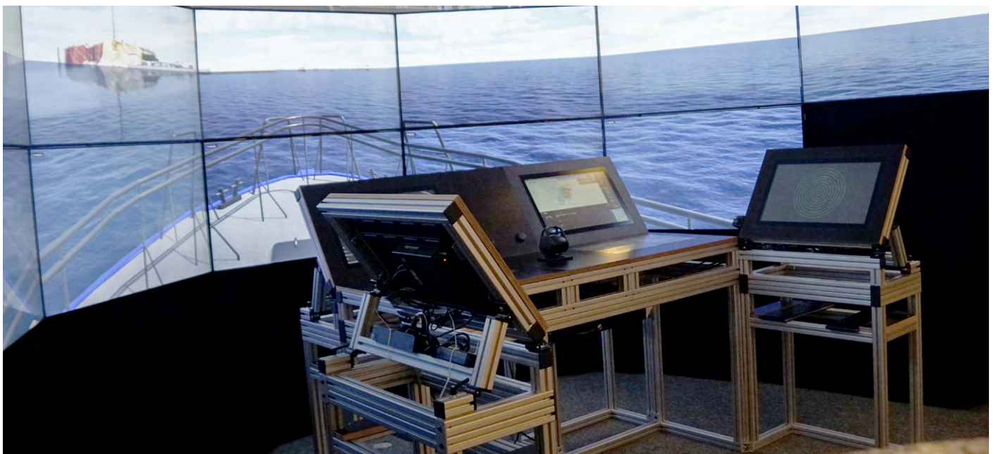
Verkehrs- und Brückensimulator der e-Maritime Integrated Reference Platform (eMIR) am OFFIS, welche unter anderem aus einem physischem Testfeld in der Deutschen Bucht und einer virtuellen Abbildung im Labor besteht
