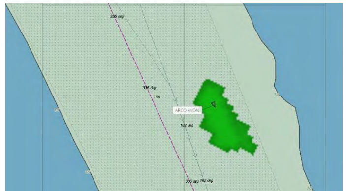
Detailaufnahme der Radarschatten über einer AIS-Positionsinformation
